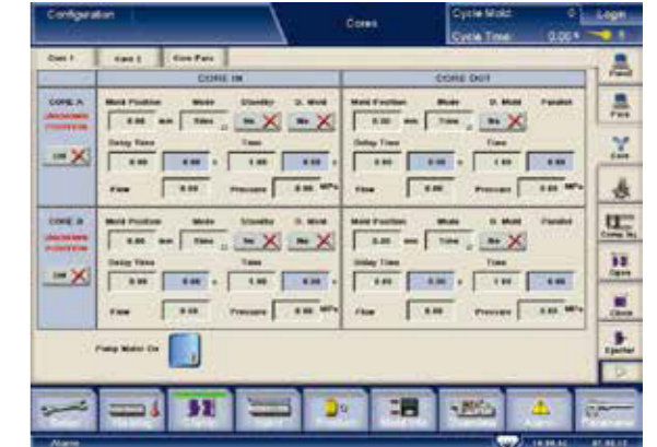
Управление скоростью и давлением гидрознаков с экрана
